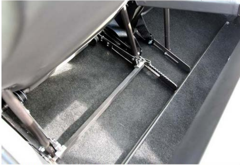
Système de réglage des sièges pour s'adapter à toutes les morphologies.
