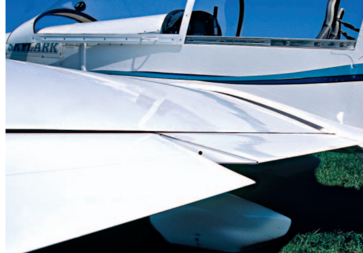
Negative Klappenstellung: Ab zirka 130 km/h fährt man die Flaps auf minus zehn Grad. Das senkt den Widerstand im Reiseflug
