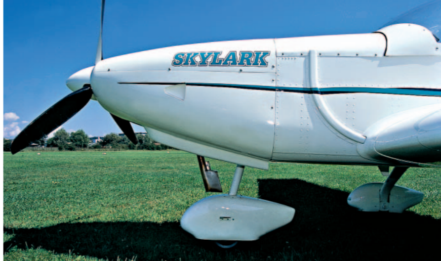
Klug verlegt: Vom Rettungssystem (vor dem Cockpit) führen die hinteren Tragegurte unter GFK-Abdeckungen zu den Spaltverkleidungen an der Flügelwurzel
