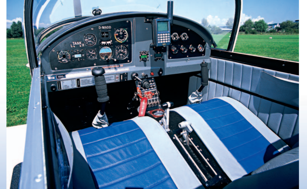
Luxusausstattung: Die D-MADD hat alle Extras, sogar Ledersitze. Im Gegensatz zum LSA wird das UL per Handhebel gebremst. Dahinter auf der Mittelkonsole die Klappenbedienung
