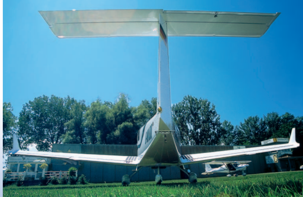
Unique Selling Point: T-Leitwerk und »richtige« Winglets prägen das Erscheinungsbild. Zum Trimmen reicht eine Klappe auf der rechten Seite; das Servo sitzt im Ruder
